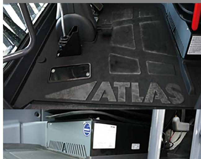
Mittagspause – Platz für Kühlbox mit Elektroanschluß – hinter dem Fahrersitz
