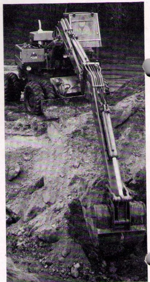
Der Hauptausleger kann in 3 verschiedenen Positionen versetzt werden. Ausleger und Knickarme in verschiedenen Größen austauschbar nach dem ATLAS-Baukastensystem. Viele spezielle Arbeitswerkzeuge. Zwei- und Mehrschalengreifer, Tieflöffel, Grabenlöffel, Profilgrabenlöffel.
