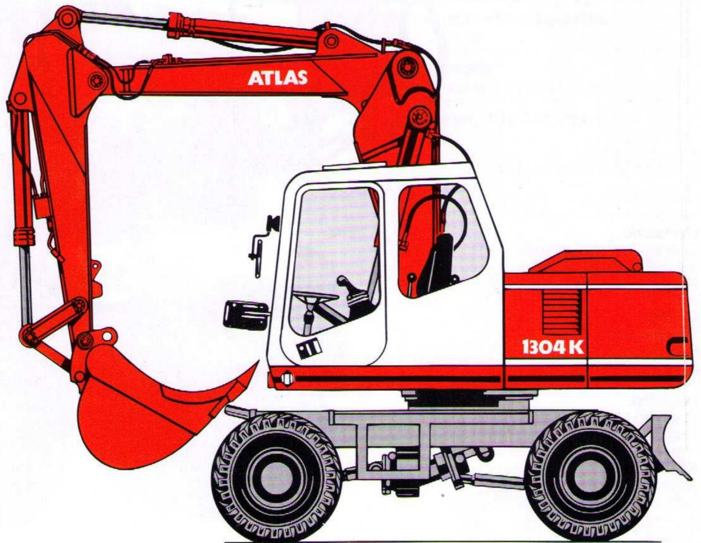
KURZHECKBAGGER, SCHWENKRADIUS 1750 oder 1575 mm
