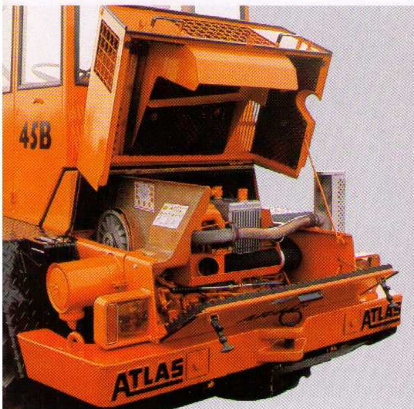
Für die große Inspektion Motorhaube steil aufklappbar.
