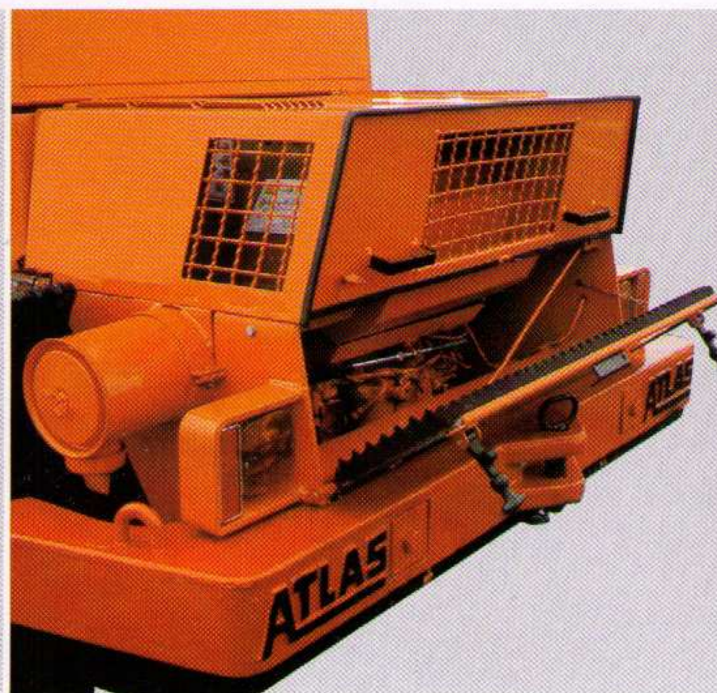
Vereinfachte Wartung durch spezielle Wartungsklappe. Trockenluftfilter von außen leicht zugänglich.
