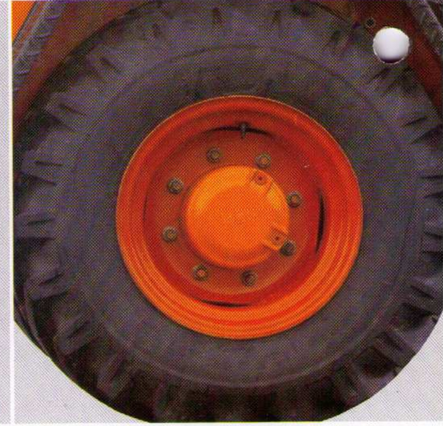
Geschlossene Planetengetriebe in den Radnaben. Doppelt gelagerte Planetenbolzen.
