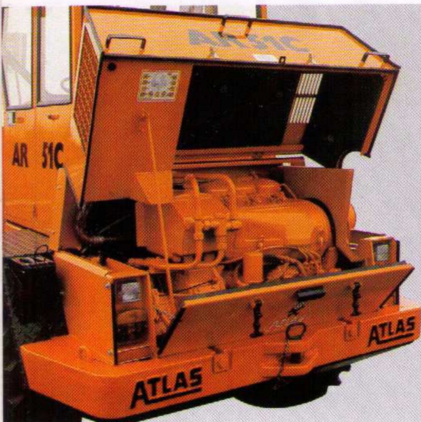
Für die große Inspektion Motorhaube steil aufklappbar.
