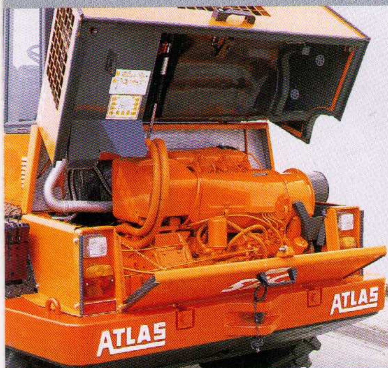
Für die große Inspektion Motorhaube steil aufklappbar.
