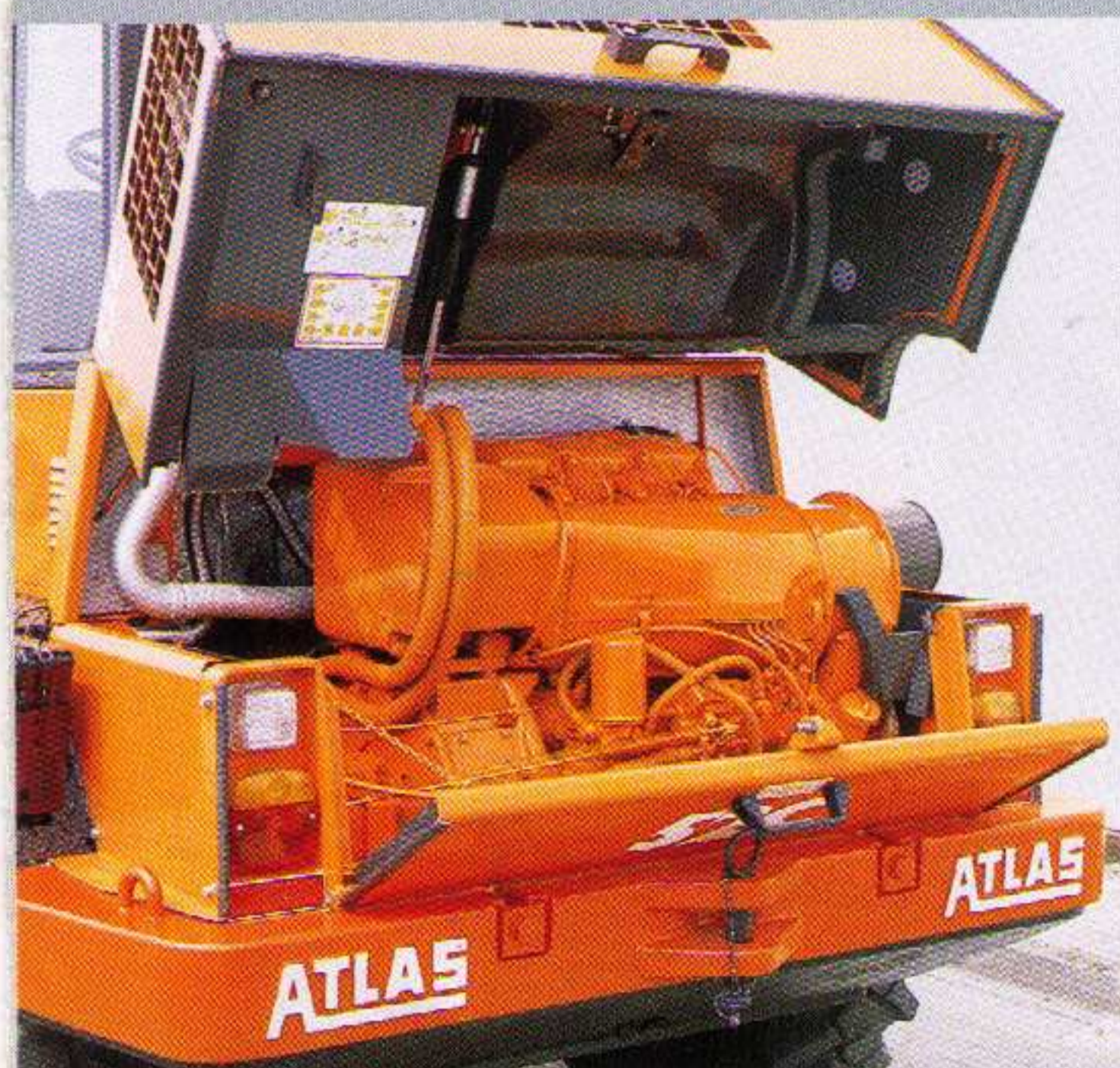
Für die große Inspektion Motorhaube steil aufklappbar.
