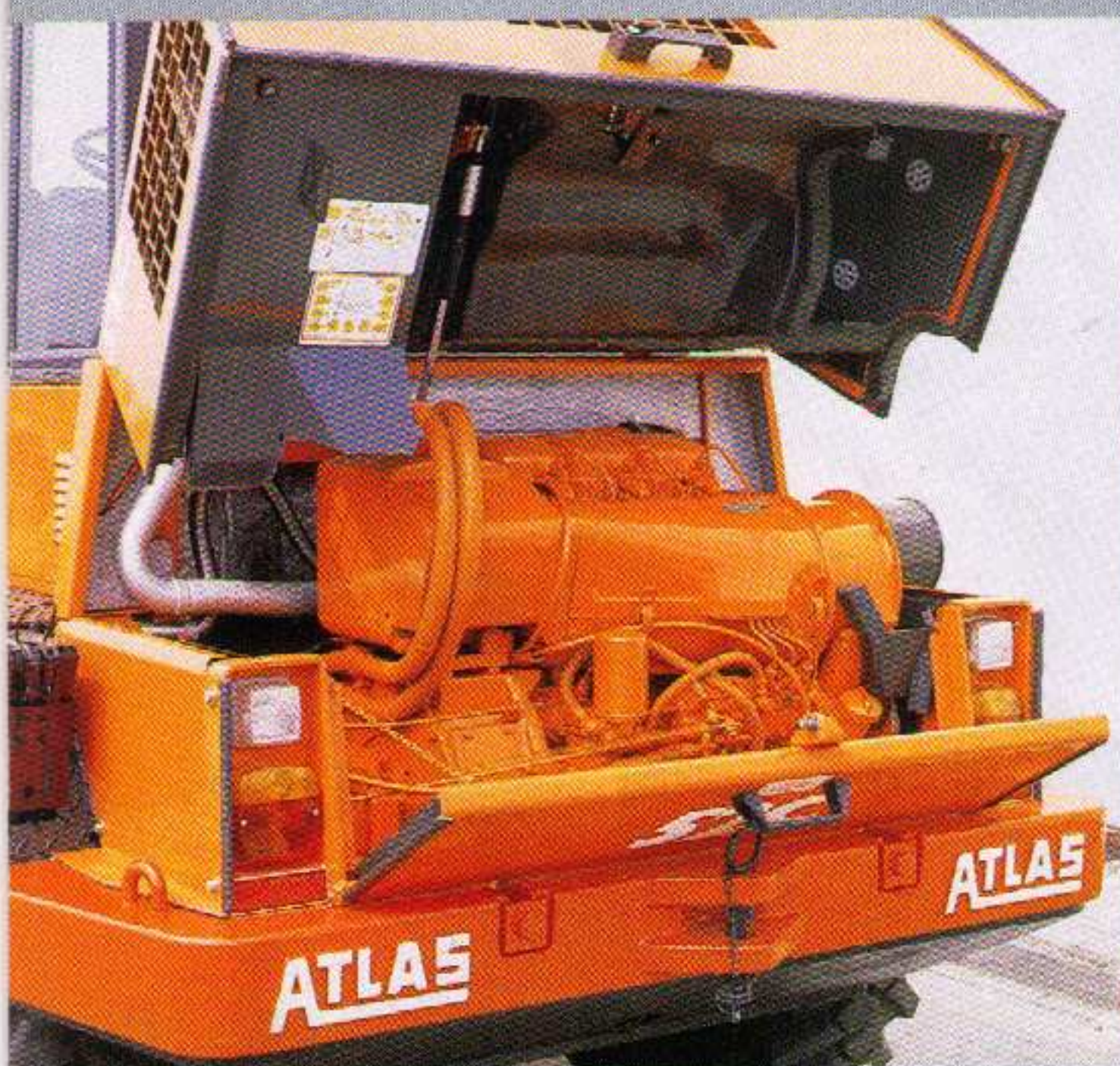
Für die große Inspektion Motorhaube steil aufklappbar.
