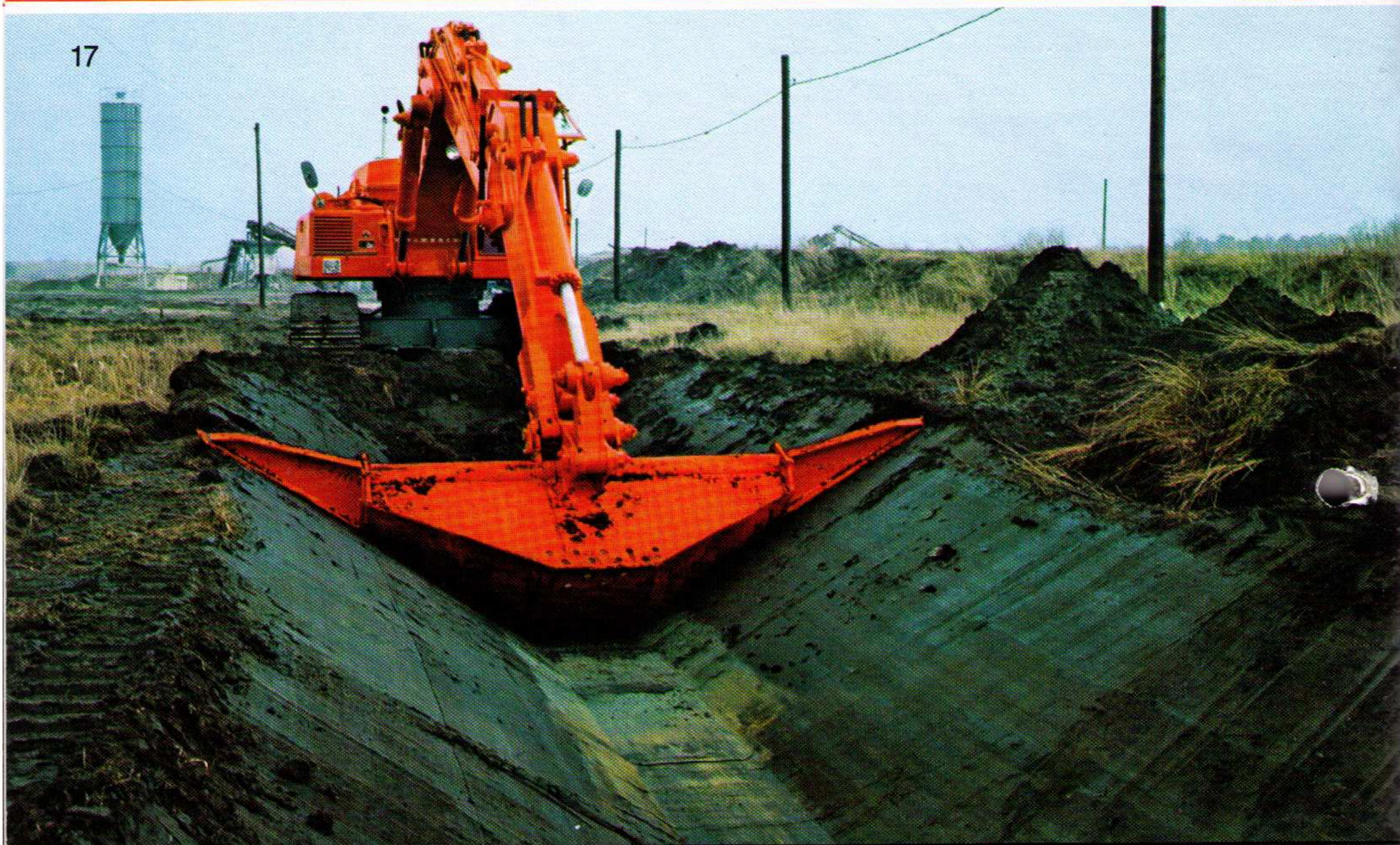
Bild 17/18 AB 1702 D mit Profilgrabenlöffel, lieferbar mit verschiedenen Böschungswinkeln, hier mit Winkel 1 : 1,5
