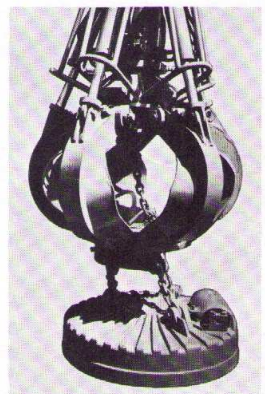
Lasthebemagnet in Mehrschalengreifer eingehängt
