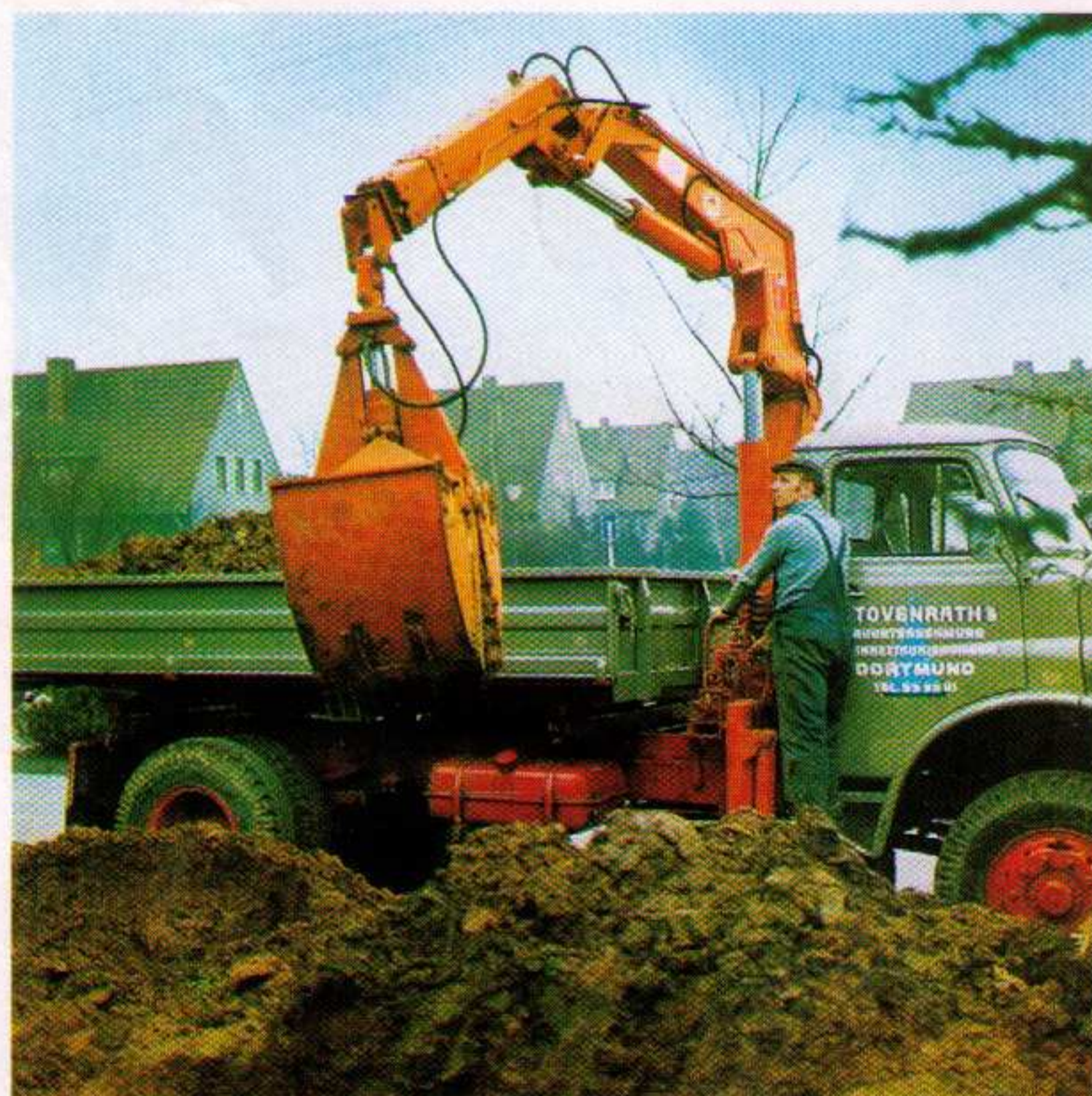
ATLAS-Ladekran 3002 bei Verladearbeiten mit Greifer
