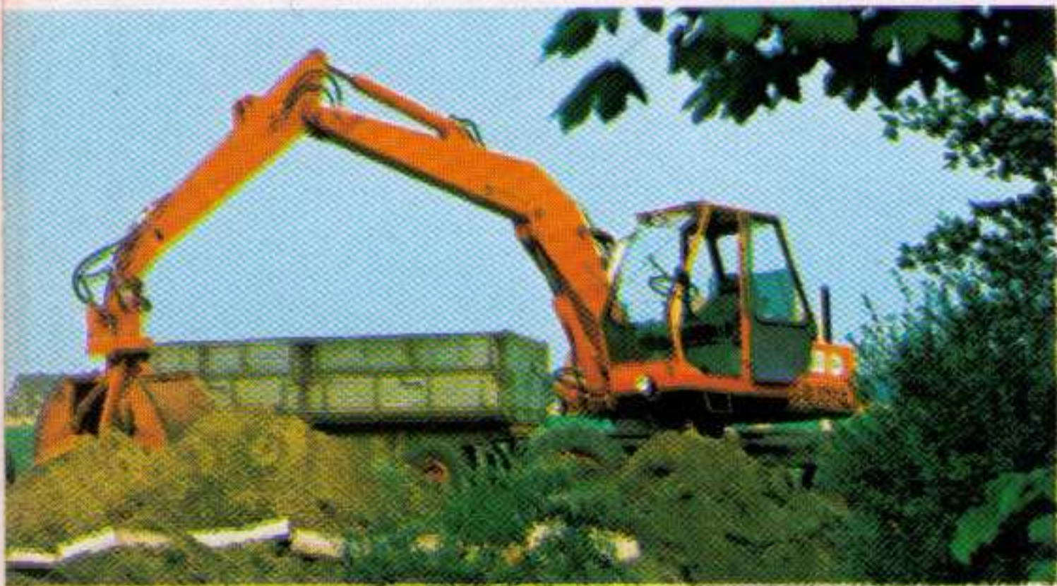
ATLAS-Entwicklung: Hydraulisches Ladegerät und Greifer, der mit hydraulischer Kraft in das Ladegut oder in den Boden gedrückt wird
