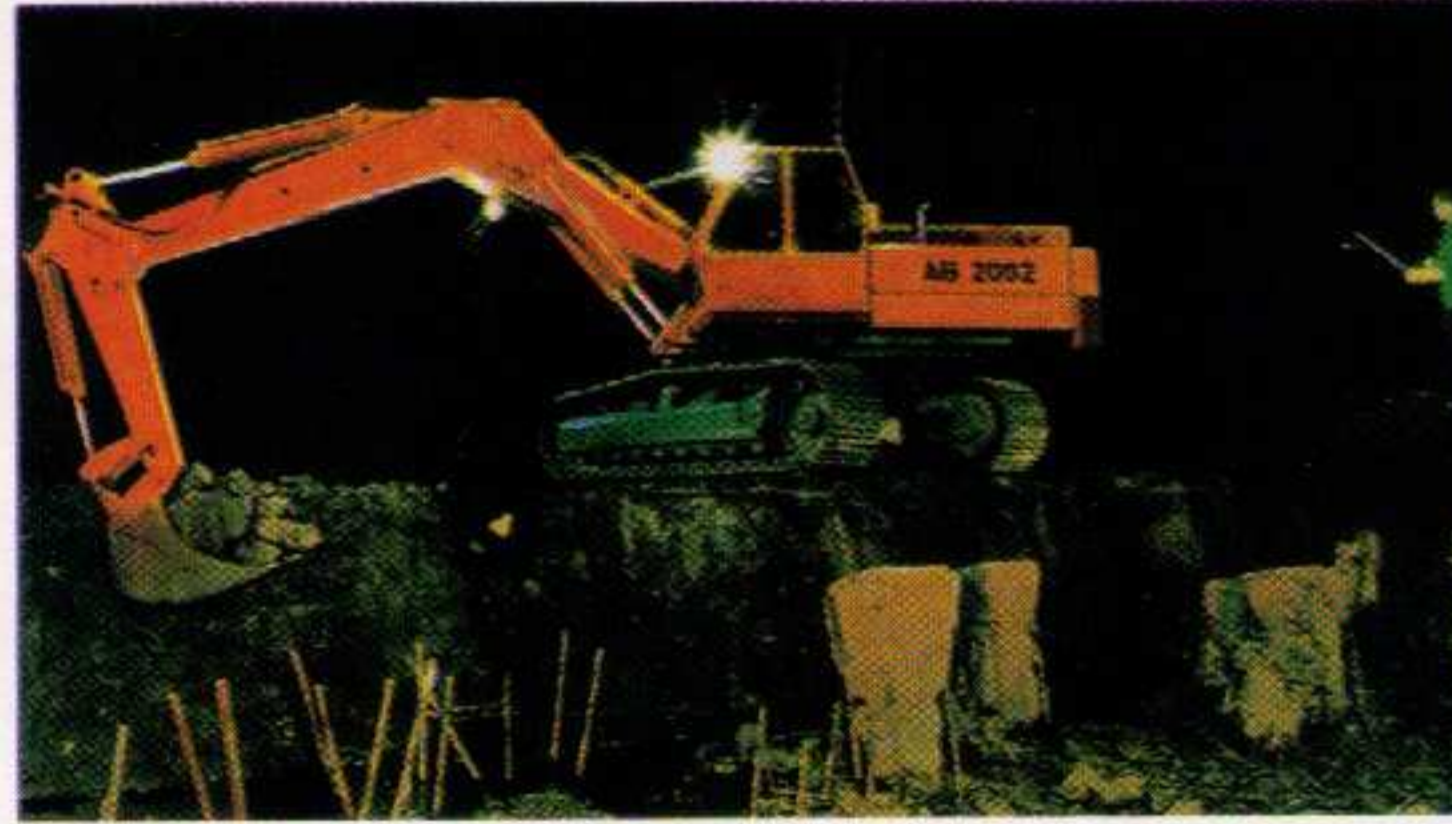
ATLAS-Entwicklung: Erster funkgesteuerter Bagger. Einführung einer Proportional-Fernschaltung über Kabel oder Funk
