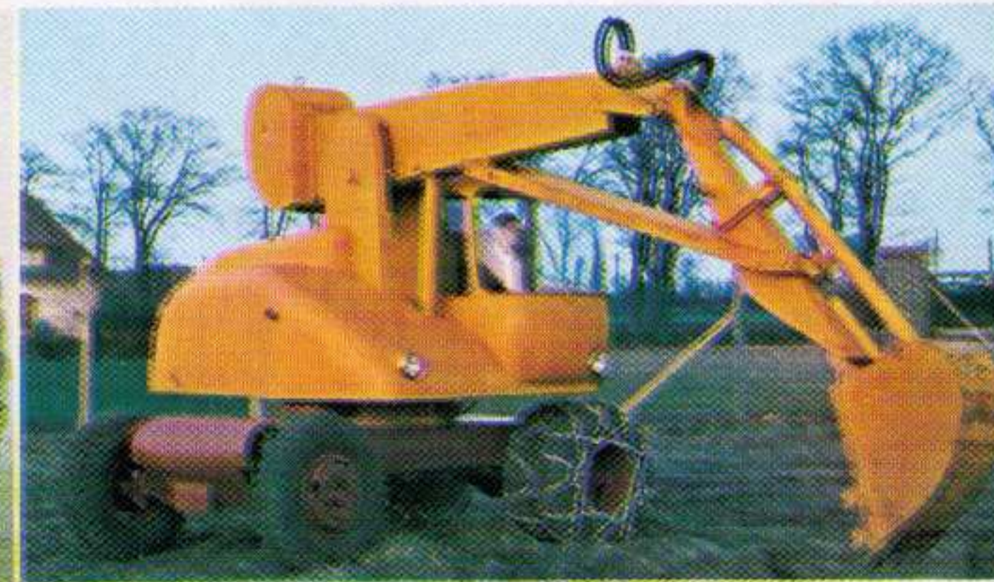
ATLAS-Entwicklung: Einsatz von 2 Regelpumpen i Hydraulikbagger, einschließlich für den Fahrtrieb
