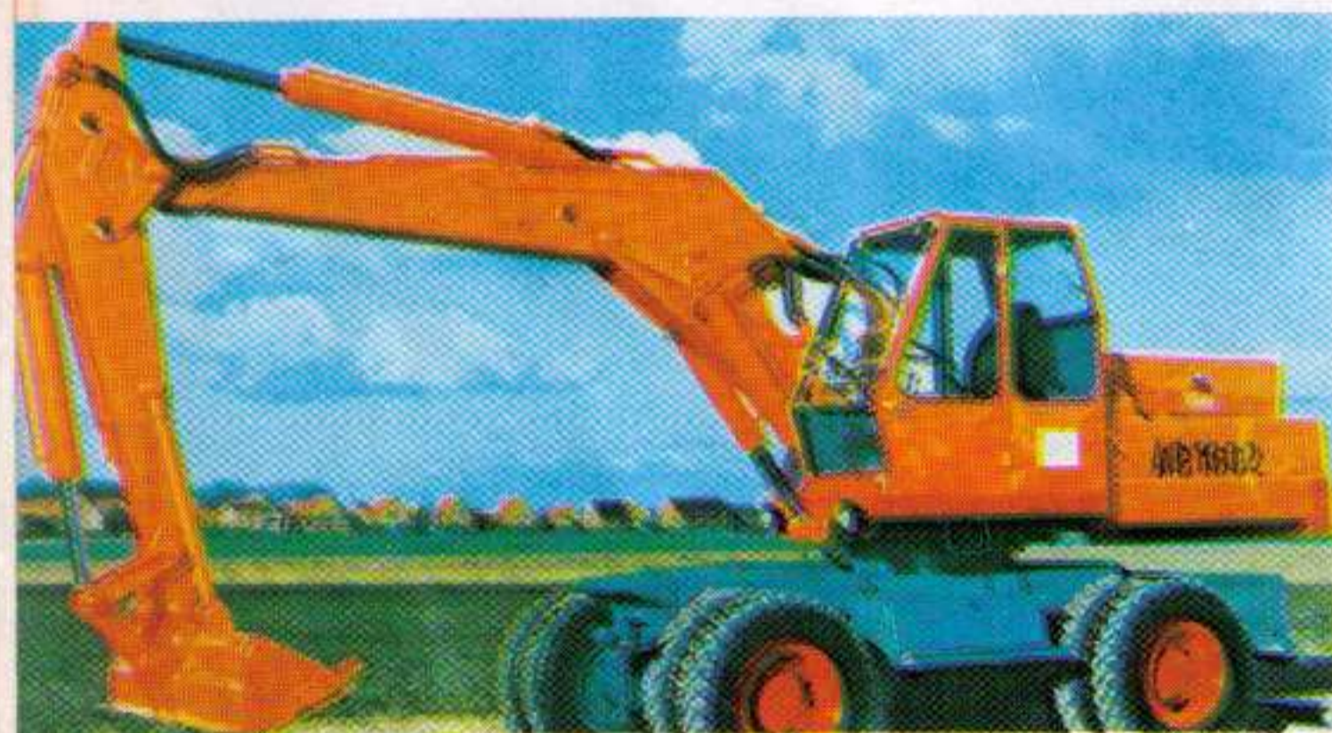
ATLAS-Entwicklung: Selbstfahrender Hydraulikbagger mit Vollsichtkanzel. Fahrgeschwindigkeit 20 km/h
