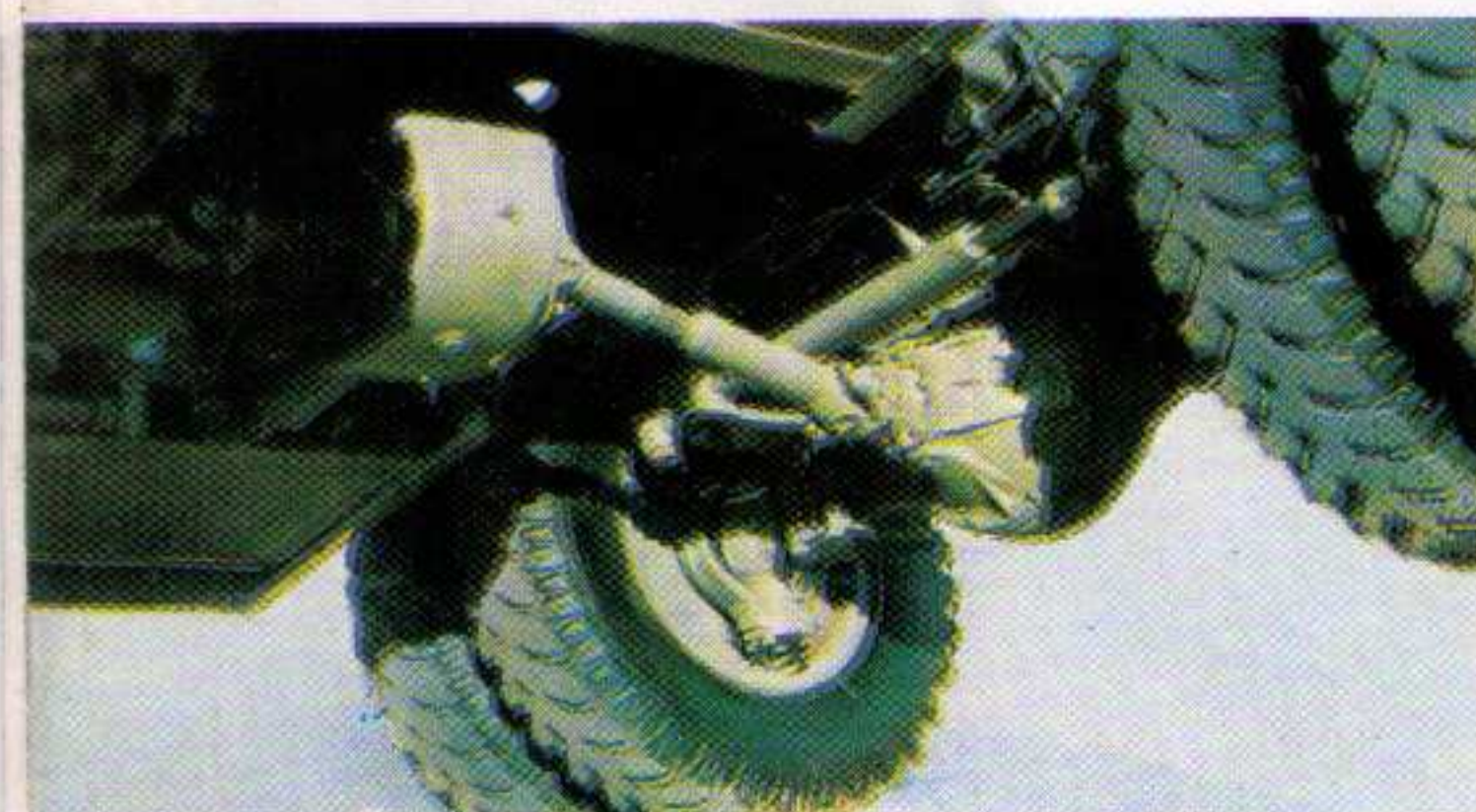
ATLAS-Entwicklung: Vollhydraulische Lenkung für Hydraulikbagger, Abschleppleinrichtung für
