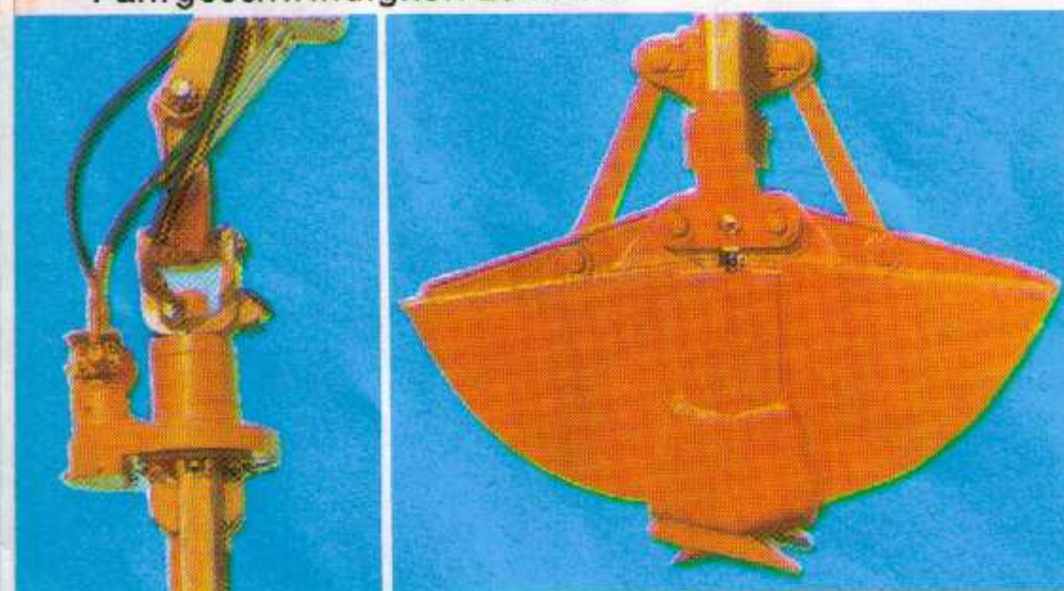
ATLAS-Entwicklung: Hydraulischer Greifer mit Auswerfer, hydraulische Greiferdreheinrichtung
