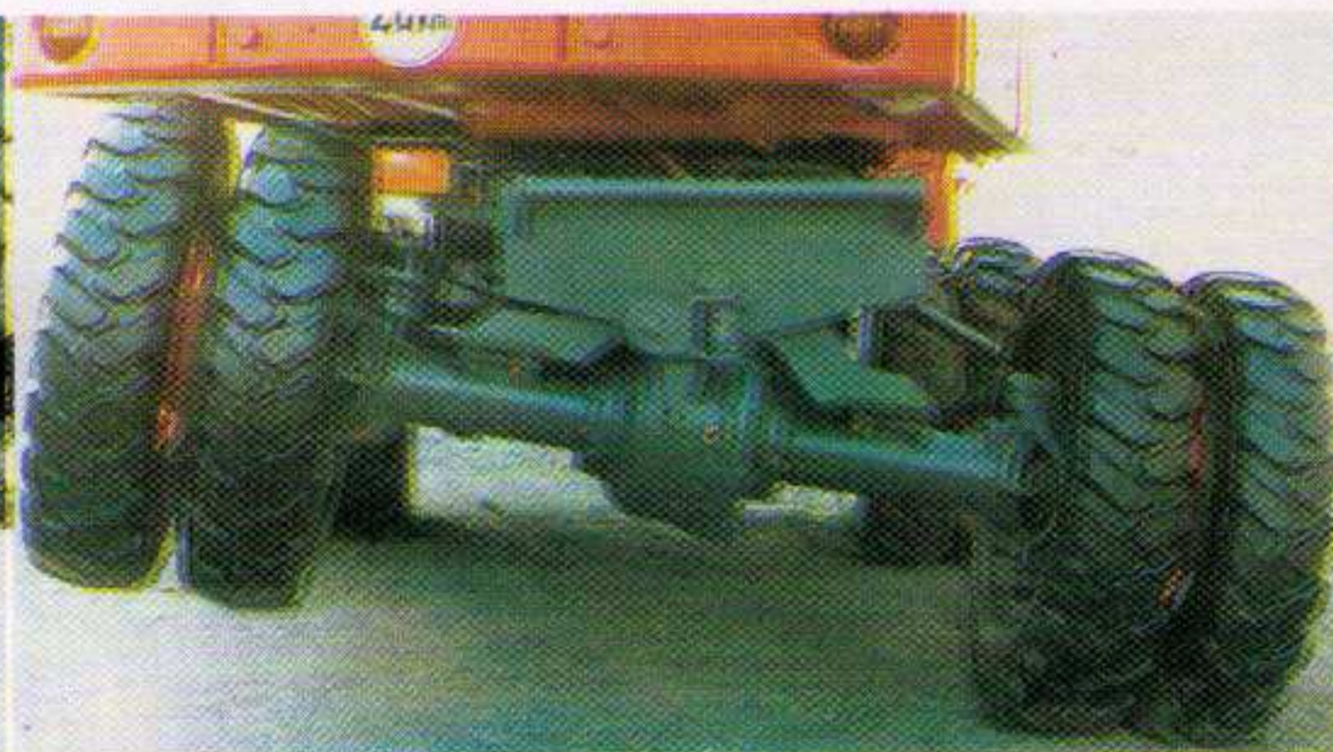
ATLAS-Entwicklung: Hydraulischer Fahrtrieb für Mobilbagger, hydraulische Abstützung der
