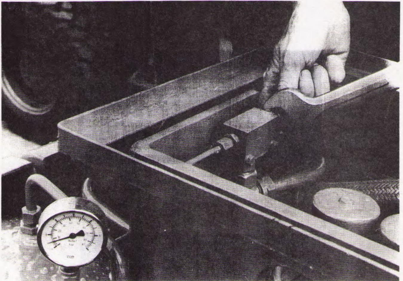
▲ Der Vorspanndruck im Hydraulikölbehälter wird über ein Druckminderventil, welches von außen einstellbar ist, automatisch auf den Einstellwert von 0,5 bar gehalten. Durch Reinschrauben der Stellschraube wird der Druck erhöht. Durch Rausdrehen vermindert. Nach einer Korrektur muß das Ventil plombiert werden.
