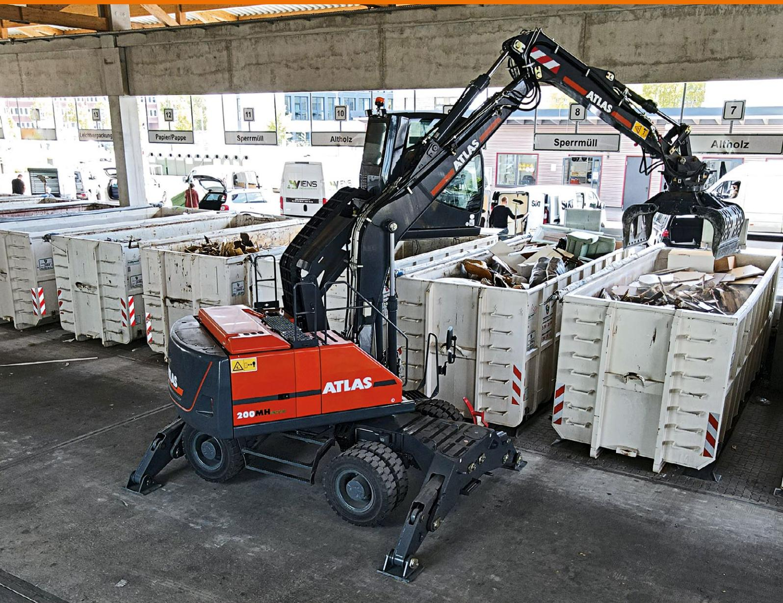
ELEKTRO UMSCHLAGMASCHINE MIT AKKU
