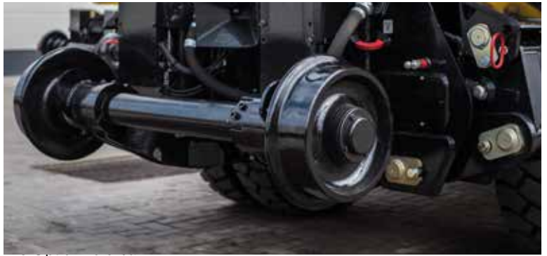
Frikitionsantriebssystem lieferbar für 1404 ZW mit Gleisbreite 1000 und 1435 mm.
