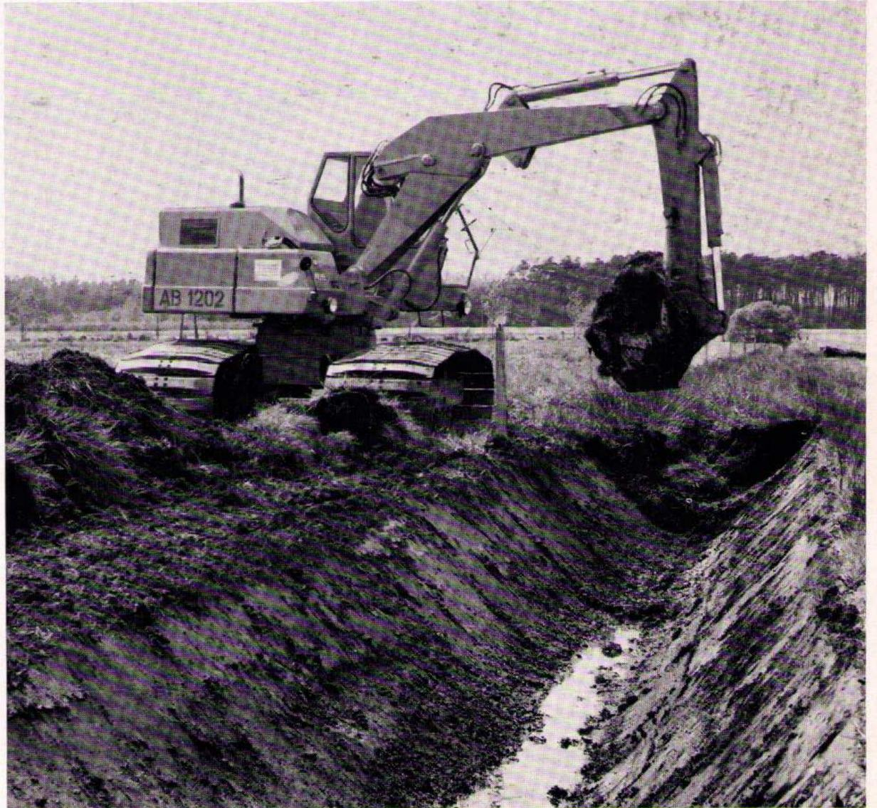
Moderner, formgestalteter Oberwagen. Alle Aggregate sind für den Wartungsdienst leicht zugänglich. Kurzes Heck gibt Bewegungsfreiheit auf engen Baustellen.
