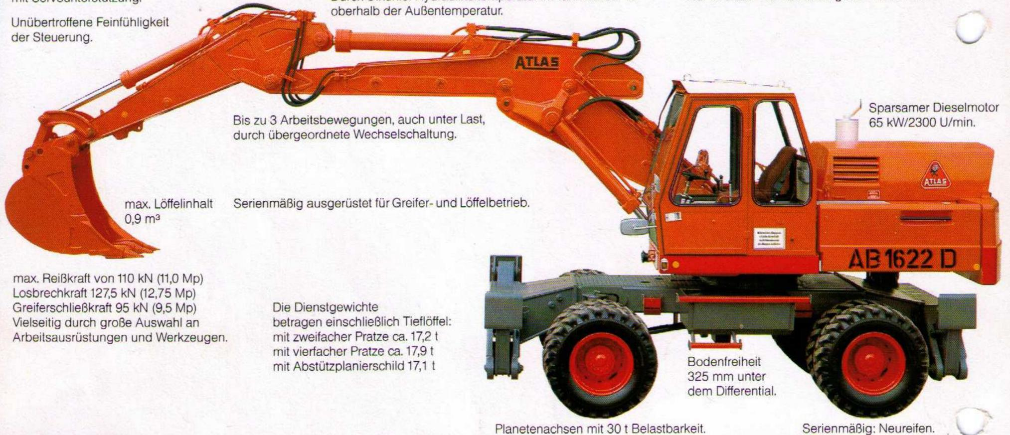
Bis zu 3 Arbeitsbewegungen, auch unter Last, durch übergeordnete Wechselschaltung.
