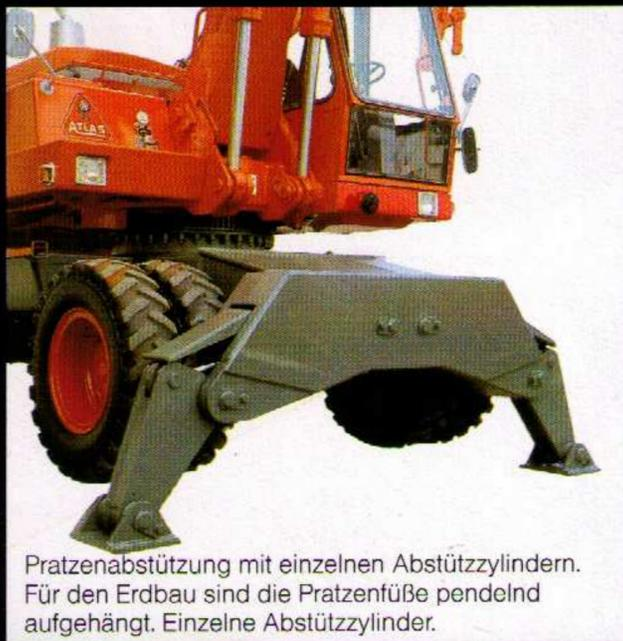
Prätzenabstützung mit einzelnen Abstützzylindern. Für den Erdbau sind die Prätzenfüße pendelnd aufgehängt. Einzelne Abstützzylinder.
