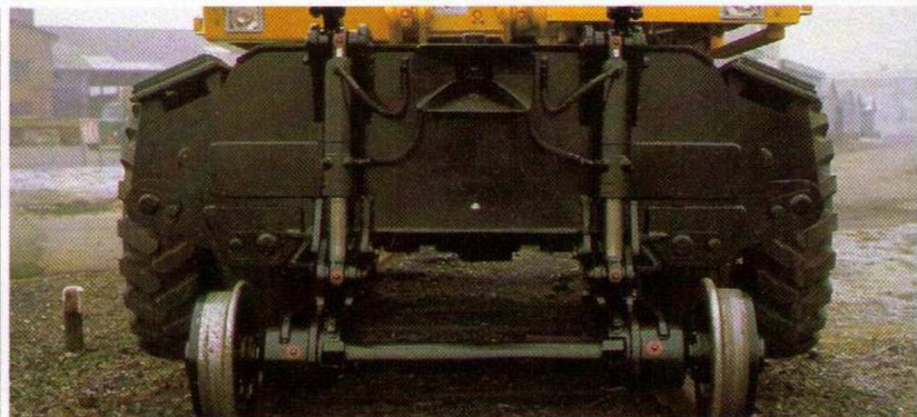
Der ATLAS 1602 E ZW kann als ungebremste Anhängelast 40 t auf der Schiene befördern – Anhängerkupplung mit Druckluftschläuchen
