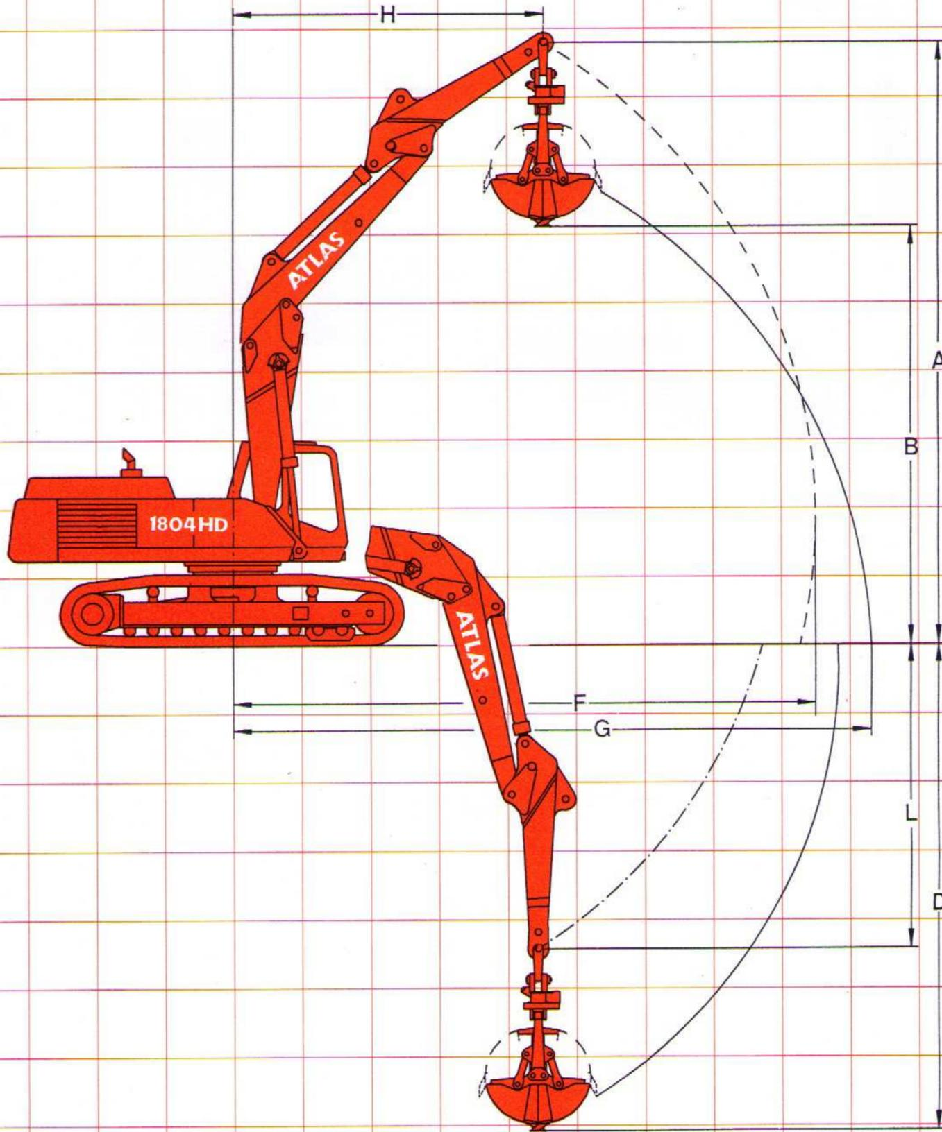
Greiferschließkraft max. 86 kN (8600 kp)
