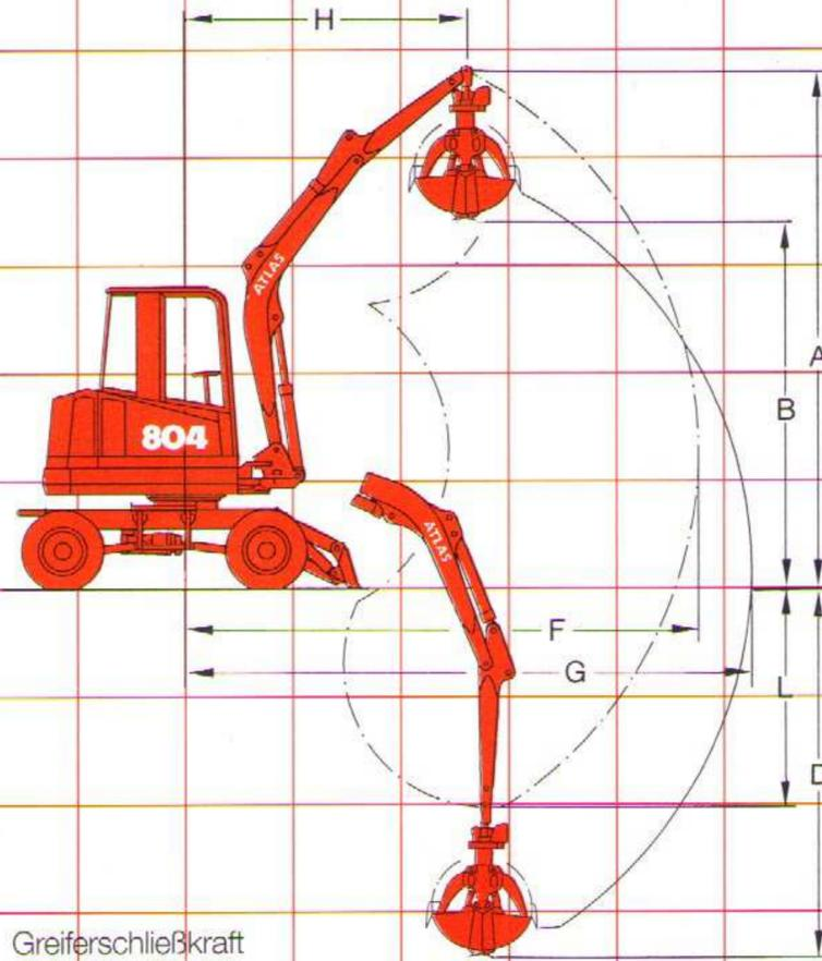
Greiferschließkraft max. 24,0 kN
