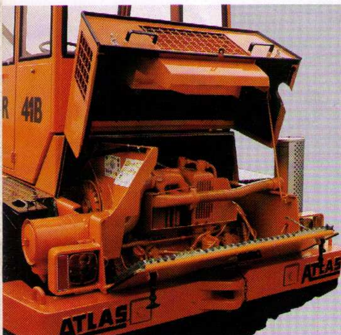
Für die große Inspektion Motorhaube steil aufklappbar.
