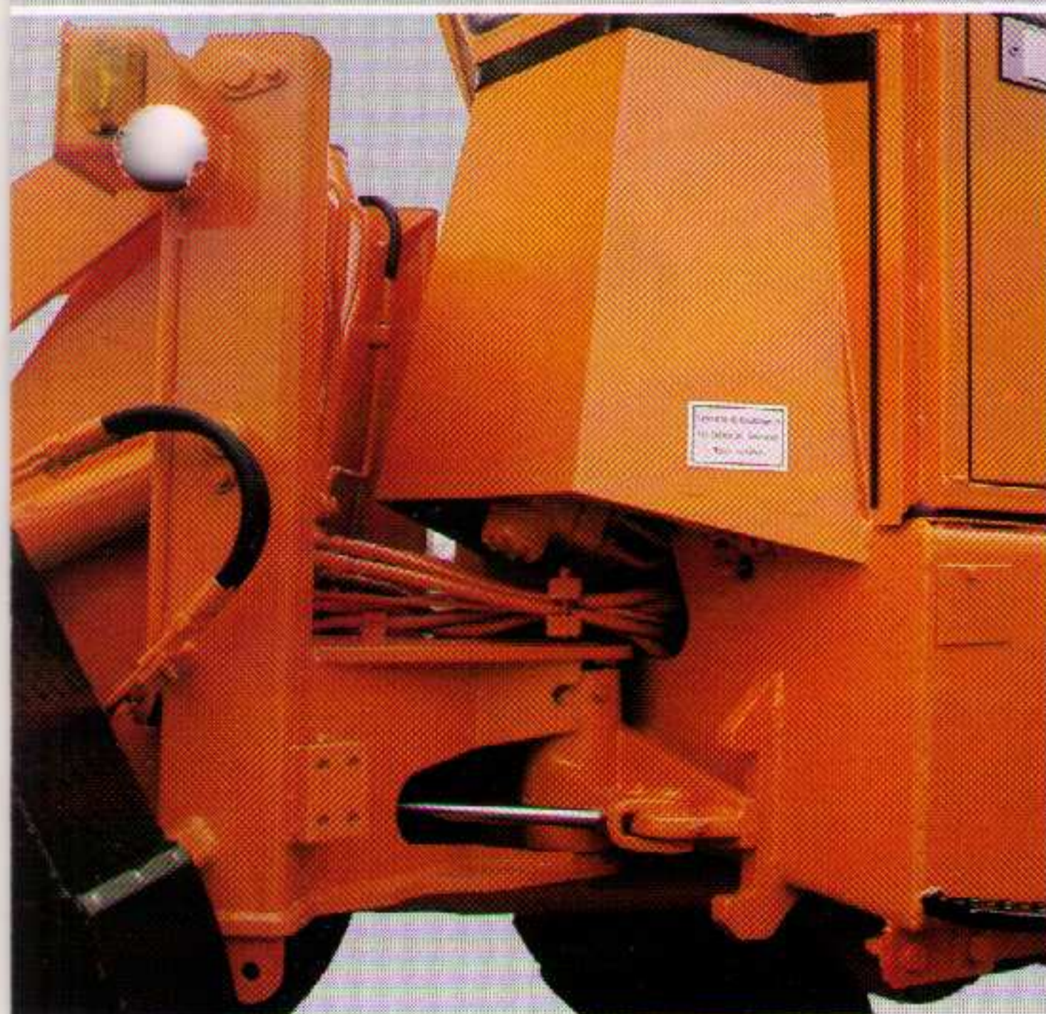
Gute Geländegängigkeit durch Knickpendelgelenk (Lagerung im Hinterwagen).
