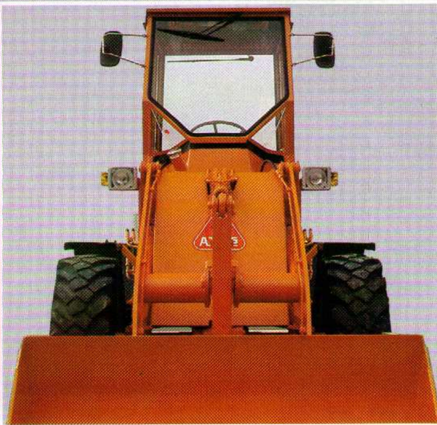
ROPS-Kabine mit ausgezeichneter Rundumsicht.
