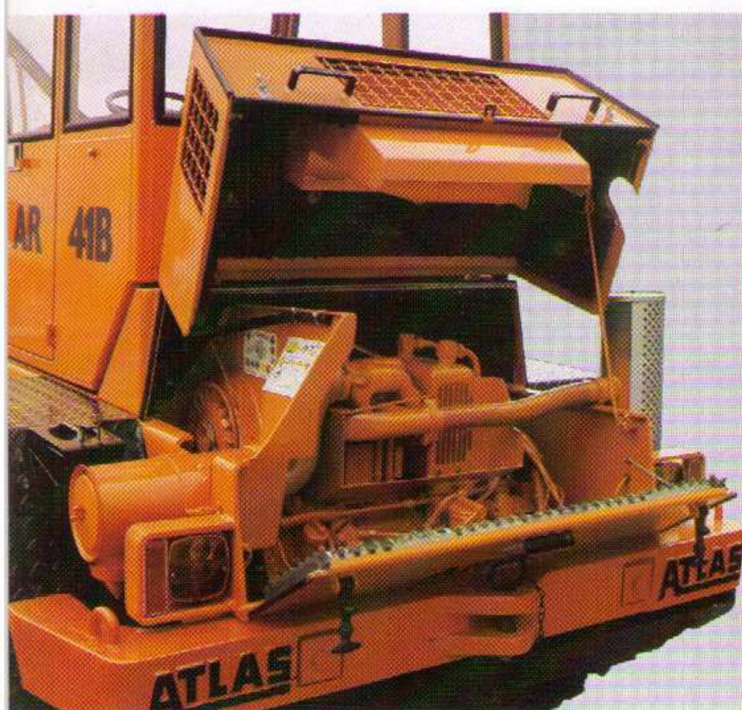
Für die große Inspektion Motorhaube steil aufklappbar.
