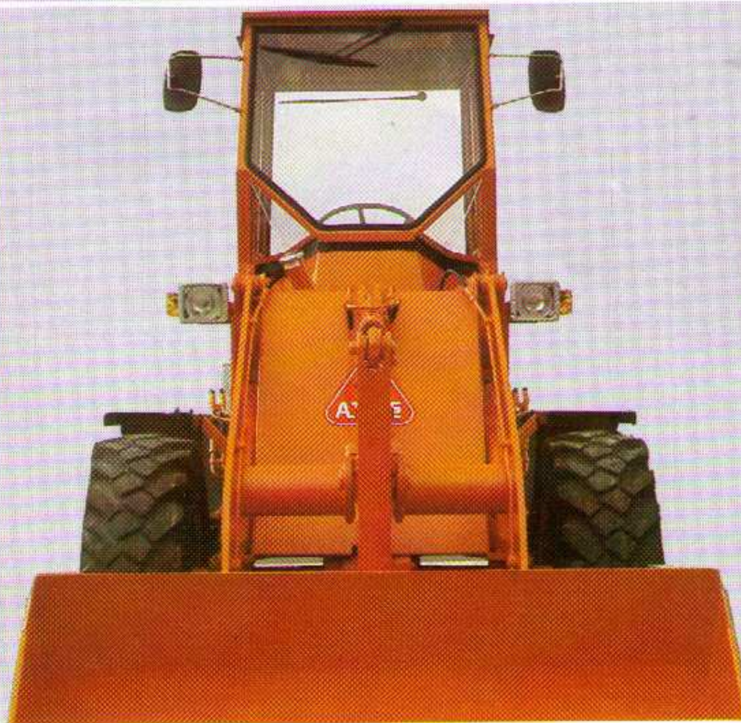
ROPS-Kabine mit ausgezeichneter Rundumsicht.
