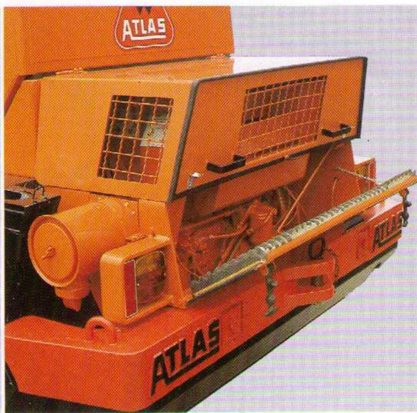
Vereinfachte Wartung durch spezielle Wartungsklappe. Trockenluftfilter von außen leicht zugänglich.
