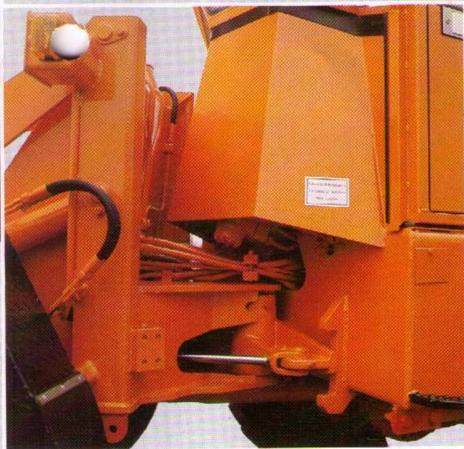
Gute Geländegängigkeit durch Knickpendelgelenk (Lagerung im Hinterwagen).
