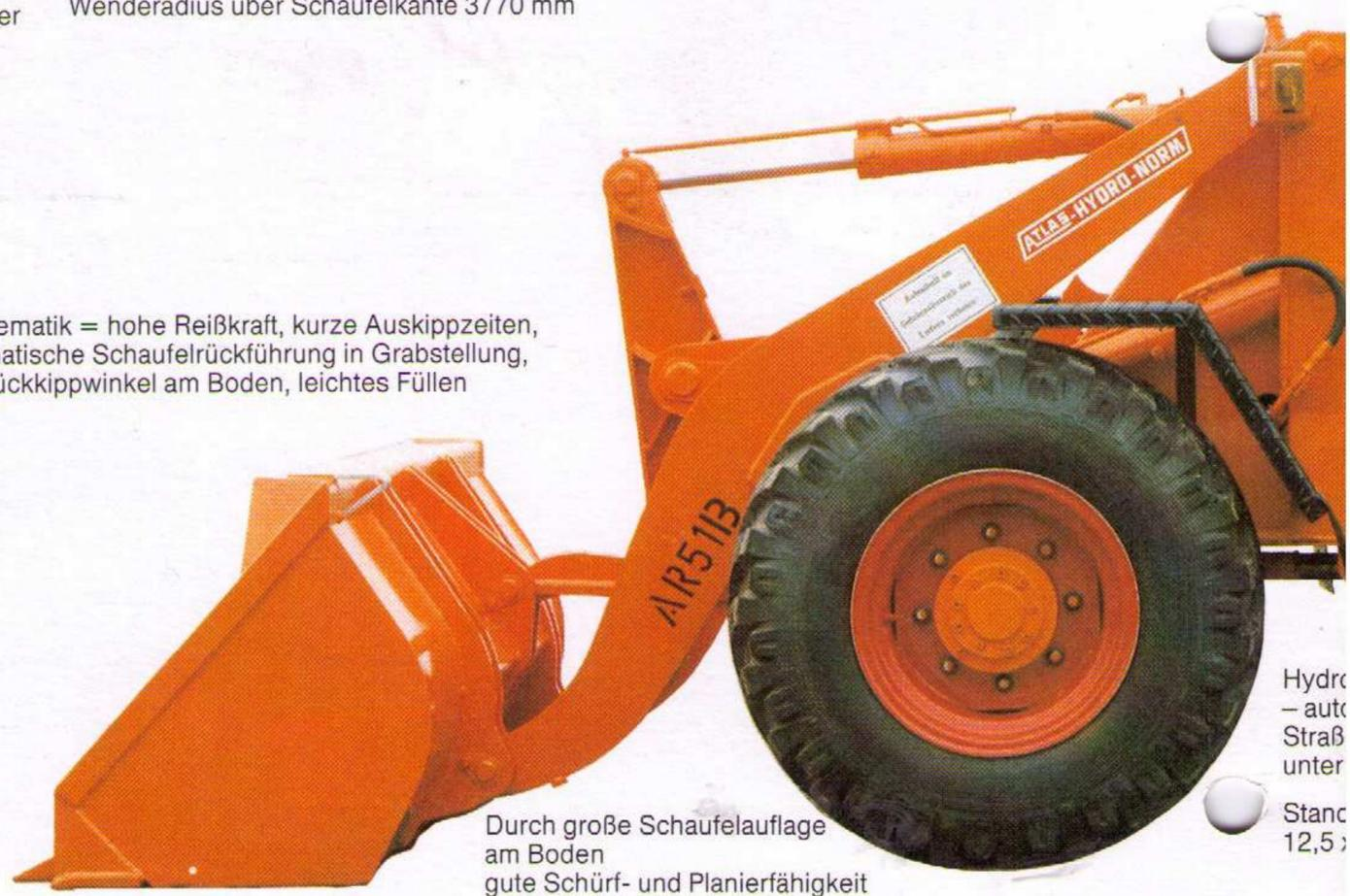
Durch große Schaufelauflage am Boden gute Schürf- und Planierfähigkeit
