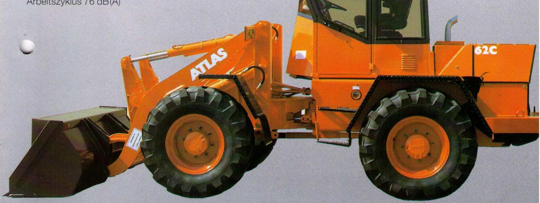
EWG Baumusterprüfung (gültig ab 24 12. 1988) Schalleistungspegel Standlauf 104 dB(A) Schalldruckpegel Kabine 84 dB(A)
