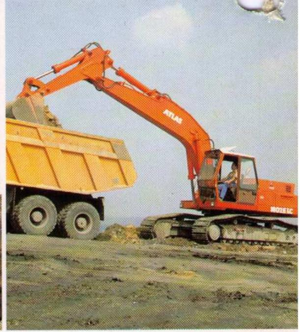
das Schwenkwerk, die Arme bis hin zum Werkzeug sind neu konstruiert, gründlich getestet und in der Praxis schon jetzt voll bewährt. – Die drei großen Raupenbagger sind wie immer bei ATLAS mit den Fahrwerken HD, LC und Standard, mit Monoblock-
