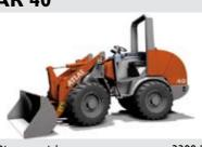
3300 kg 29,4 kW (40 PS) Motorleistung Schaufelinhalt 0,50 m<sup>3</sup>
