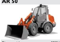
3950 kg 42 kW (57 PS) Motorleistung Schaufelinhalt 0,70 m<sup>3</sup>
