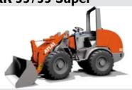
2500 kg / 2875 kg Motorleistung 24,6 kW (33,5 PS) / 29,4 kW (40 PS) Schaufelinhalt 0,34 m<sup>3</sup> - 0,40 m<sup>3</sup>
